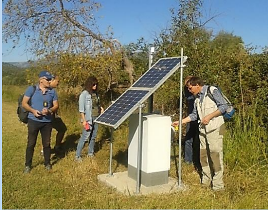
Corint Körfezi, Yunanistan yakınlarda bir delikte bulunan bir dizi sismometreden biri için kayıt ekipmanı
