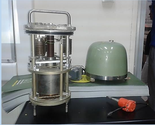
Solda eski, sağda daha modern iki sismometre, Patras Sismoloji Laboratuvarı, Yunanistan
