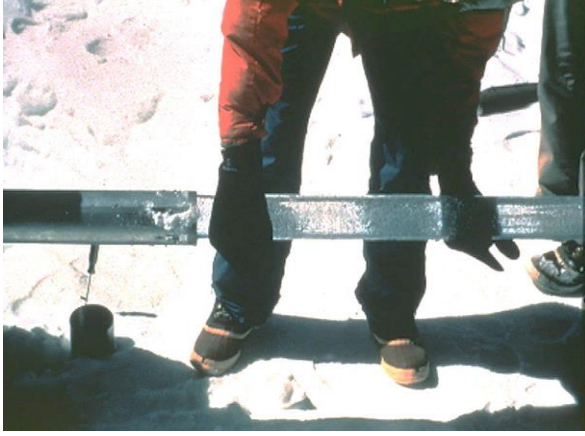
Şekil 4.58. Bir buz sondaj kuyusundan alınan bir karot tüpten bir buz karotunun çıkarılması
