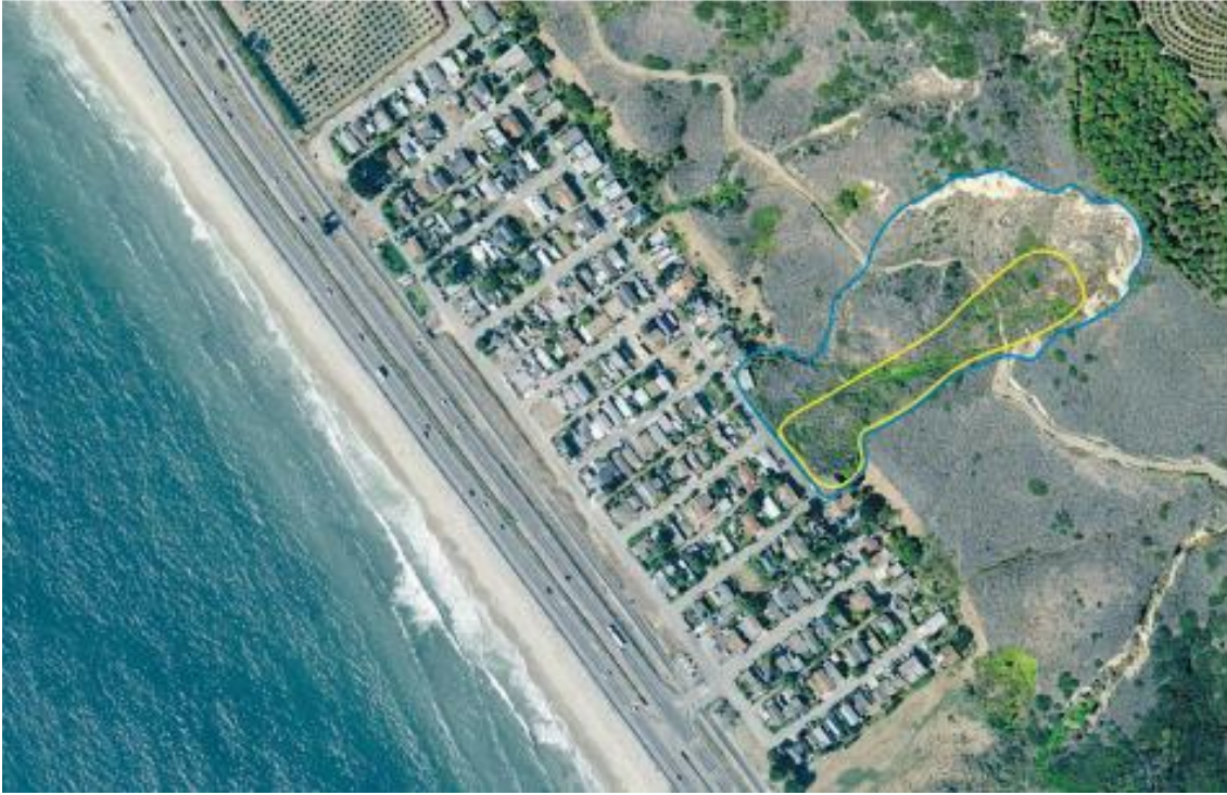
Şekil B 4. La Conchita heyelanının (Kaliforniya, ABD) 2005 tarihinde çekilmiş hava fotoğrafındaki konumu. Mavi poligon daha eski, sarı poligon ise yeni heyelan sınırını göstermektedir (AirPhoto USA ve Ventura yerleşimi (Kaliforniya) izniyle ve Randy Jibson, USGS).
