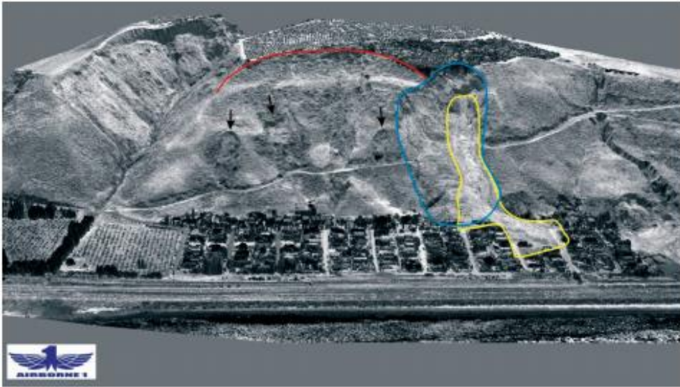
Şekil B 7. La Conchita heyelanının (Kaliforniya, ABD) 2005 yılında çekilmiş verev LiDAR görüntüsü. 1995 (mavi) ve 2005 (sarı) tarihli heyelan sınırları gösterilmiştir. Siyah oklar bölgedeki diğer heyelanları göstermektedir. Kırmızı çizgi ise tüm kayalık alanı içeren eski bir heyelanın ana aynasını göstermektedir. (Fotoğraf: Airborne 1, El Segundo, Kaliforniya (ABD) ve Randy Jibson, USGS).
