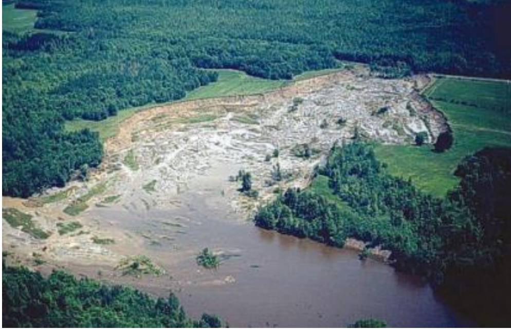
Şekil 20. 1993 Lemieux heyelanı. Ottawa (Kanada) bölgesinde hassas denizel kil birimi içerisinde gelişen hızlı toprak akması. Heyelan ana aynası nehir kıyısından itibaren 680m gerilemiştir. Yaklaşık 2.8 milyon ton kil ve silt birimi sıvılaşarak South Nation nehri vadisine akarak heyelan seti oluşturmuştur (Fotoğraf: G.R. Brooks, CGS).
