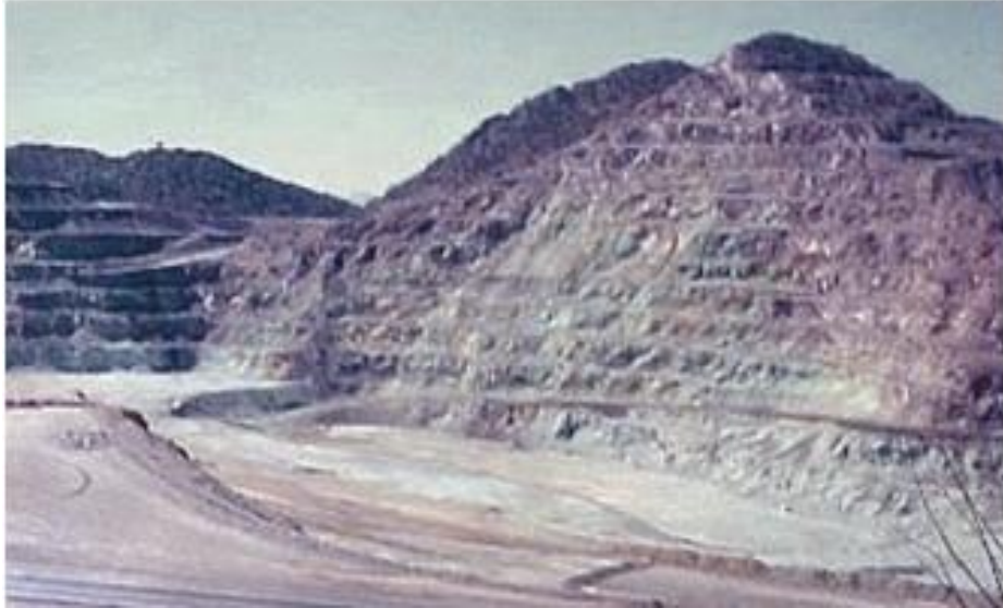
Şekil C 28. Tuscon maden sahasında (Arizona, ABD) kaya şev basamaklarının şematik ve arazi görünümü (Şekil kaynak 11'den, Fotoğraf: Setve Dutch, Wisconsin Üniversitesi, ABD).
