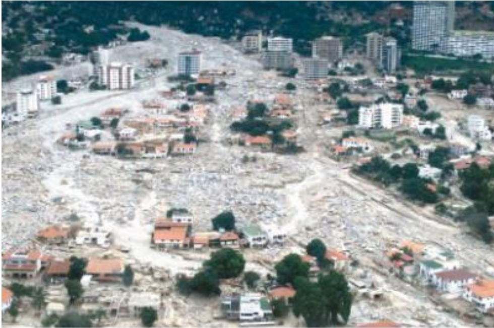
Şekil 14. Venezuela'nın kuzey kıyısındaki, Cordillera de la Costan eteklerinde bulunan Caraballeda şehrinde moloz akmasının yol açtığı hasarlar. Aralık 1999'da meydana gelen olay, Venezuela'da 20. Yüzyılda yaşanmış en büyük doğal afettir. Birkaç gün süren sağanak yağışların tetiklemesiyle oluşan moloz akmaları 30000 kişinin ölümüne yol açmıştır (Fotoğraf: L.M. Smith, Waterways Experiment Station, U.S. Army Corps of Engineers).
