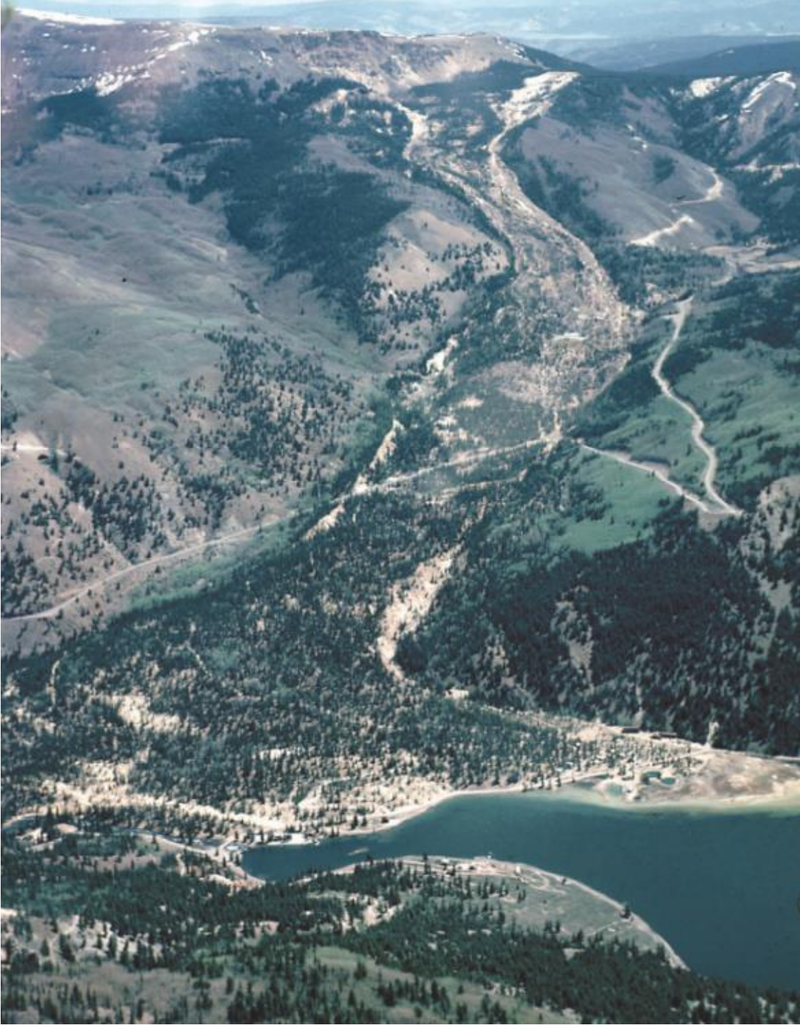
Şekil 32. Slumgullion (Kolarado – ABD) heyelanı. Bu heyelan Gunnison nehri üzerinde set oluşturmuş vadide taşkınlara ve Cristobal heyelan set gölünün oluşmasına yol açmıştır (Fotoğraf: Jeff Coe, USGS).
