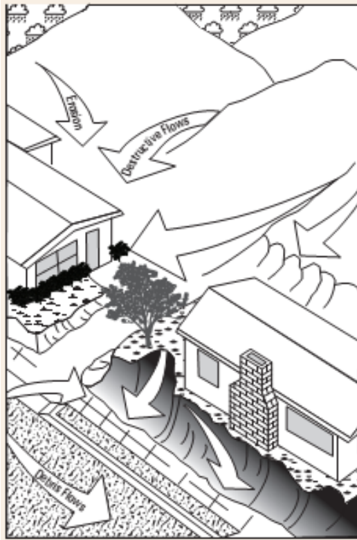
Şekil C 38. Moloz akması ve/veya çamur akmasına karşı korunmasız bir yapı. Moloz akması olası tehlikelerini azaltmak için uygulanabilecek bazı yaklaşımlar Şekil C39'da verilmiştir.
